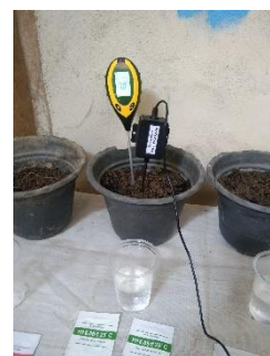
Gambar 3. 2 Pengujian Sensor pH tanah
