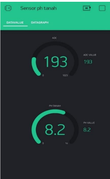
Gambar 4 Tampilan Blynk Pada halaman ini akan di tampilkan hasil dari deteksi sensor kadar nutrisi pada tanah, untuk mengetahui apakah tanah tersebut basah atau asam dengan melihat hasil dari sensor PH tanah, skala ph tanah berkisar dari 0-14 dengan
