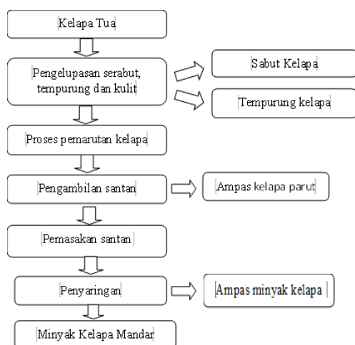
Gambar 1. Alur Proses produksi Minyak Kelapa Mandar
