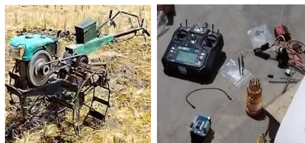
Gambar 2. Traktor Tangan berpengerak Remote Control (Nir-awak) hasil Rakitan dan Beberapa Komponen
