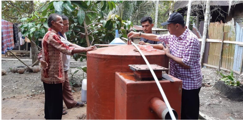
Gambar 1. Set-up Bioreaktor Anaerobik Kapasitas 1500 L Untuk Produksi Pupuk Organik Cair Secara Kontiniu
