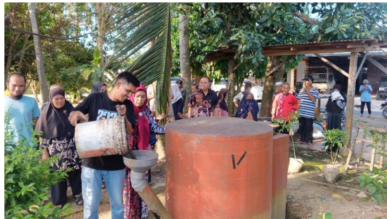
Gambar 8. Pemasukan Umpan Ke Dalam Bioreaktor Anaerobik
